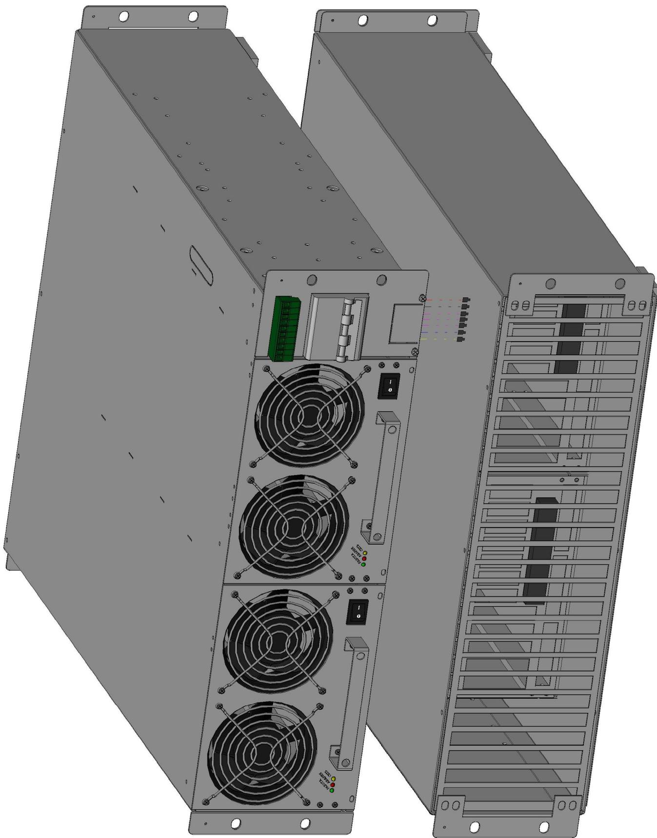
**ГАБАРИТНЫЙ ЧЕРТЕЖ КОРЗИНЫ ИПС С УСТАНОВЛЕННЫМИ СИЛОВЫМИ МОДУЛЯМИ**
