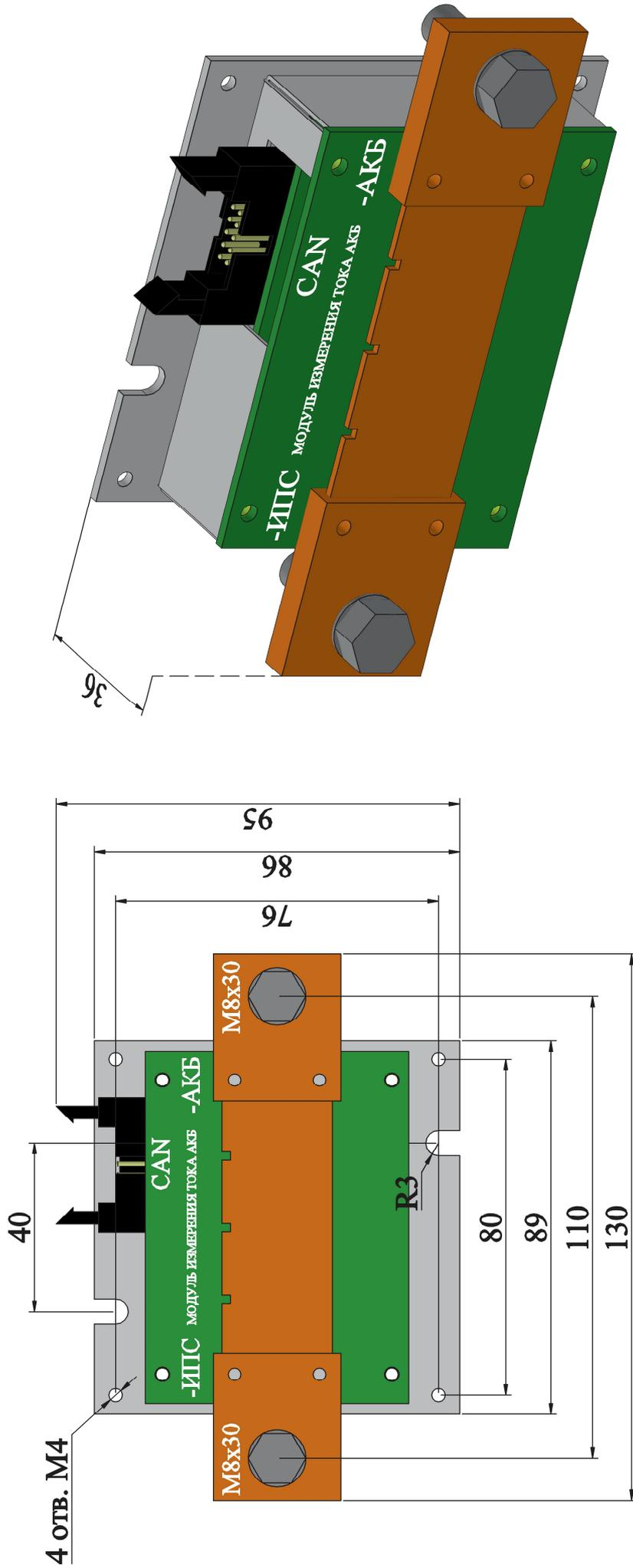
ПЛАТЫ CAN EDG. ОБЩИЙ ВИД. ГАБАРИТНЫЙ ЧЕРТЕЖ. РАСПИНОВКА
