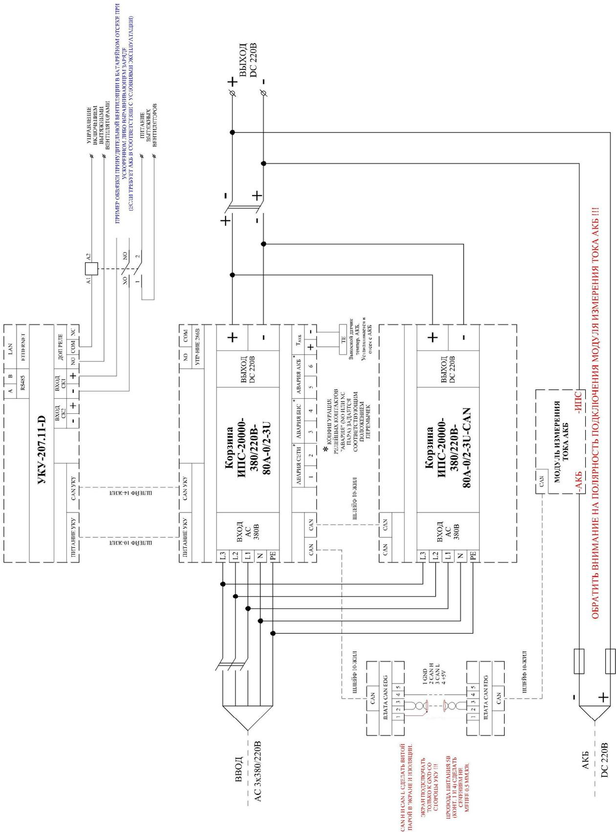
CAN H И CAN L СДЕЛАТЬ ВИТОЙ ПАРОЙ В ЭКРАНЕ И ТЕКЛОИЗЛ. ЭКРАНЫ ПОДКЛЮЧАТЬ ТОЛЬКО К GND СО СТОРОНЫ УКУ !!!
