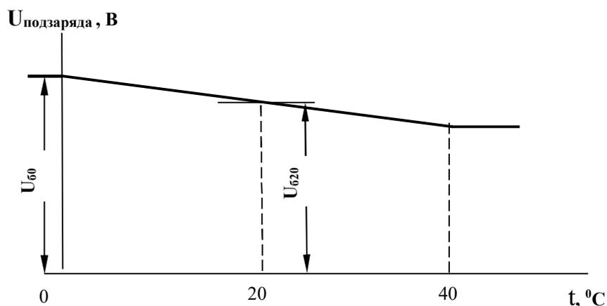
Напряжение на выходе ИПС линейно изменяется при изменении температуры датчика  $t_1$  от 0 до 40°C. В установках задаются напряжение на выходе ИПС при 0°C-  $U_{60}$  и при 20°C-  $U_{620}$ .
