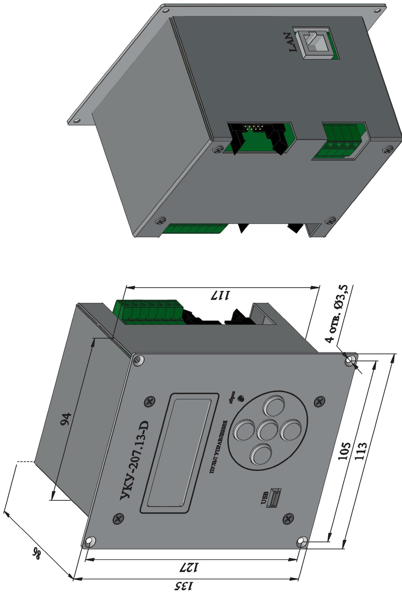
ГАБАРИТНЫЙ ЧЕРТЕЖ МОДУЛЯ ИЗМЕРЕНИЯ ТОКА АКБ 100А
