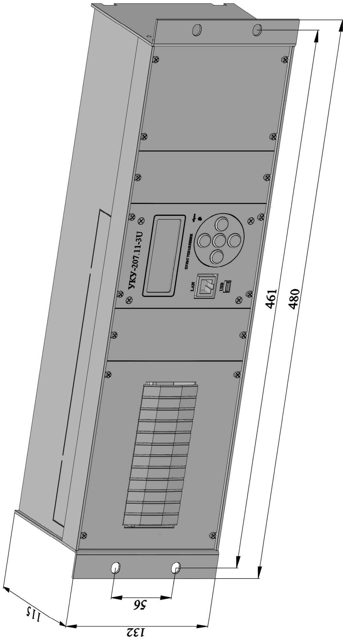
ГАБАРИТНЫЙ ЧЕРТЕЖ УКУ ВЫНОСНОГО ИСПОЛНЕНИЯ ДЛЯ УСТАНОВКИ НА ДВЕРЬ ШКАФА (УКУ-207.11-D)
