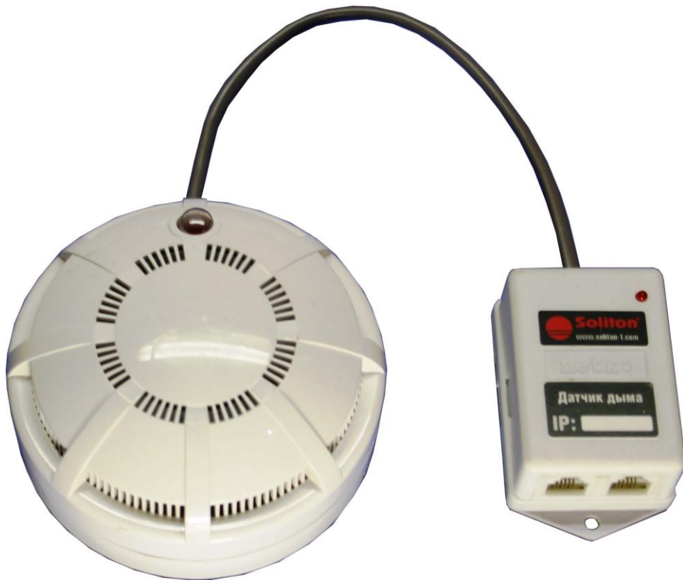
Внешний вид датчика задымления с подключенным пожарным извещателем ИП212-45.
