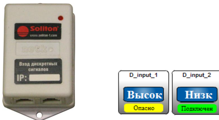
Внешний вид датчика ввода дискретных сигналов и его отображение в окне управления контроллером.
