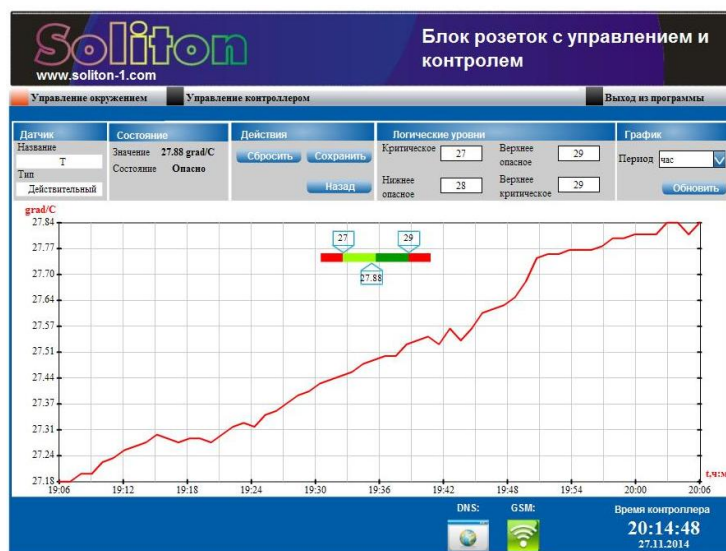
Окно управления датчиком температуры
